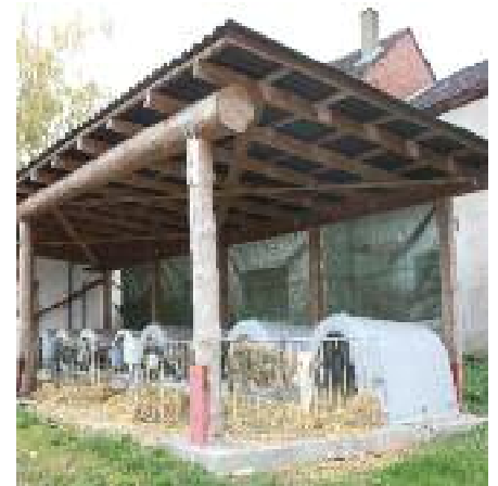
Wenn Iglus überdacht stehen hilft das dem Mensch und dem Kalb. Die Einstreu wird nicht immer nass und damit liegen die Kälber trockener und eine Überdachung stellt eine Arbeitserleichterung dar.
